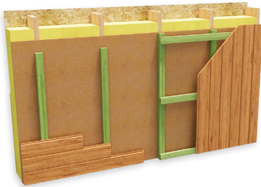
Fig 3 : Système de bardage en bois rainuré-languetté approuvé D-s2, d0.
