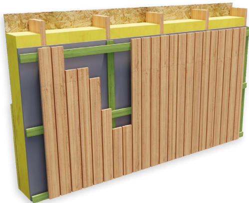
Fig. 4 : Système de bardage en bois ajouré D-s2, d0.
