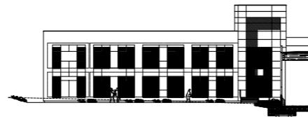
“Le volume contenant les bureaux est réalisé avec une structure poutres-colonnes en lamellé-collé.”
