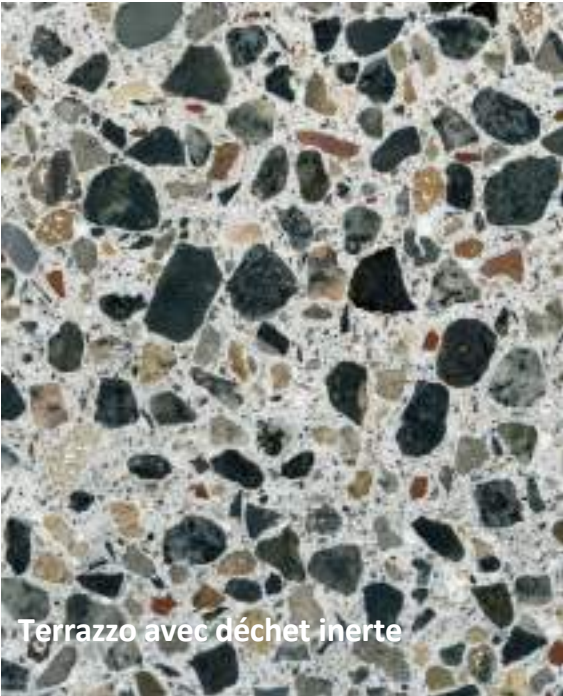
Terrazzo avec déchet de construction ( verre / carrelage / profil aluminium)
